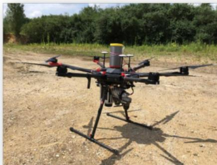
Drone DJI M600 Pro + Thermal camera<sup>2</sup>
